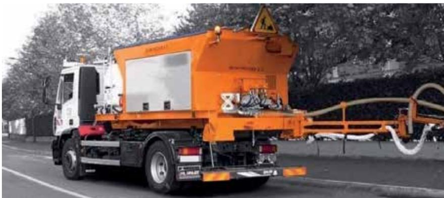
Avec uniquement un remplissage de gravillons (4/6) et d'émulsion (69 %) il est possible de boucher les trous, de desflacher ou rendre imperméable une partie de la chaussée. Après la mise en place de panneaux afin de signaler aux usagers la zone de chantier, il n'y a plus qu'à mettre la machine en marche et commencer à réparer.
